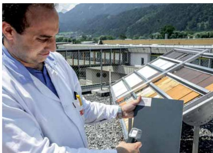
Versuch bei prallem Sonnenschein auf dem Dach des Herstellers in Schwaz: Durch die Ausrüstung mit dem Anti-Heat-Zusatz weist die Musterfläche eine deutlich niedrigere Oberflächentemperatur auf.
