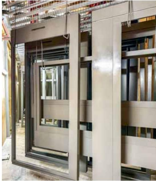
In den Wenger-Hallen werden die mehr als 6500 Fensterelemente mit „Aquawood Covatop XT“ samt Anti-Heat-Zusatz in einem schlammgrauen Farbton lackiert.
